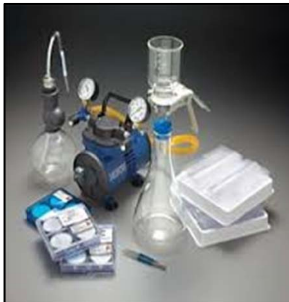
شکل ۳-۴- پمپ و ظروف برای فیلتراسیون
