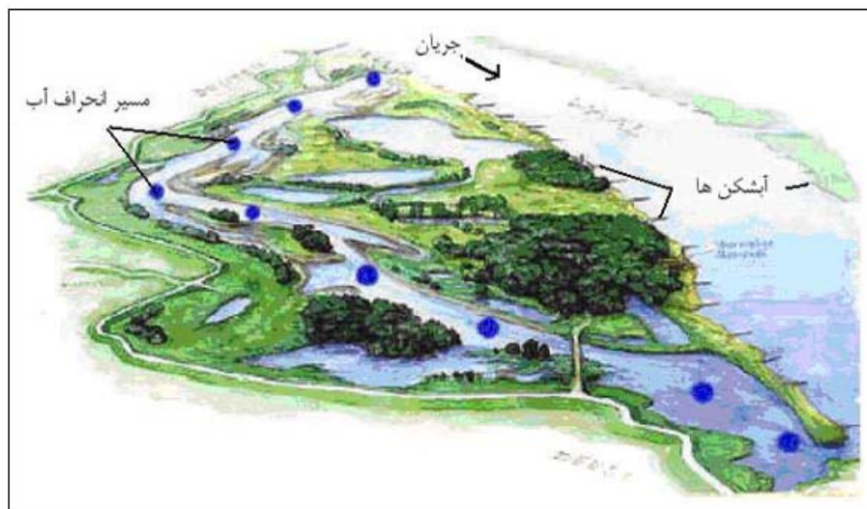
شکل ۷-۵- انحراف موضعی رودخانه وال (هلند) از طریق یک آبراهه طبیعی برای ساخت آبشکن‌ها [۱۴۵]
