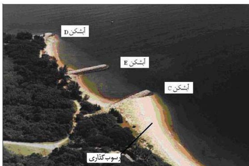
شکل ۸-۴- توسعه مناسب رسوبات در پایین دست آبشکن C و ناکارایی آبشکن‌های D و E [۱۸۲]
