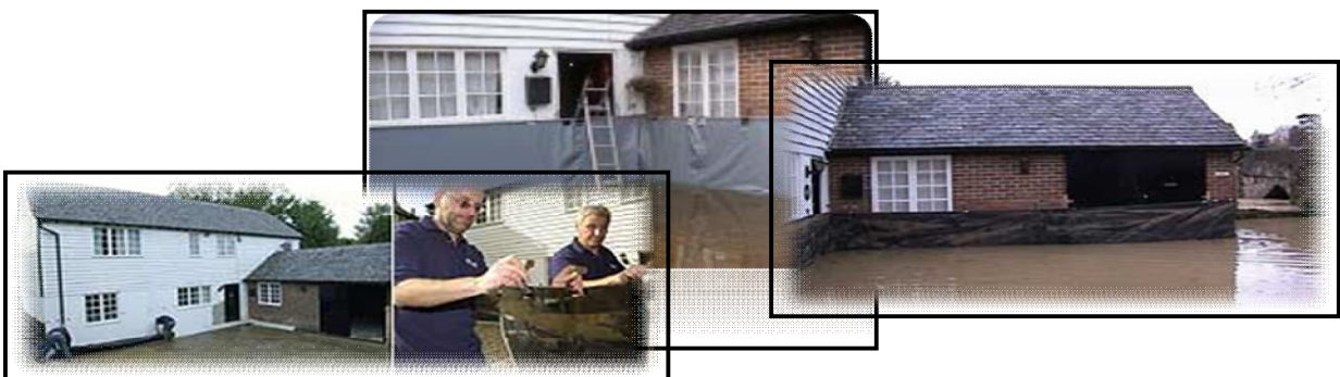
شکل ۳-۸- استفاده از پارچه‌های ضدسیلاب در پادسیل‌سازی خشک [۳۸]
