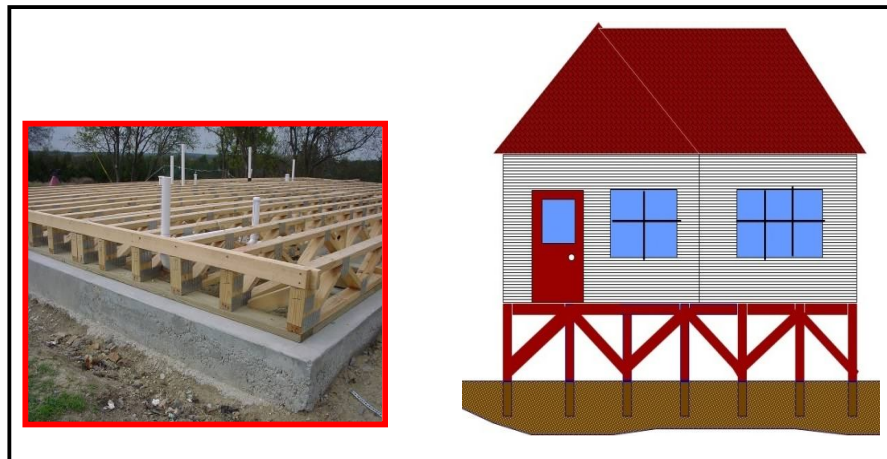
شکل ۳-۲- استفاده از شمع برای افزایش ارتفاع
