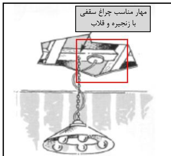
شکل ۴-۱۳- نحوه مهار مناسب چراغ آویز توسط زنجیر
