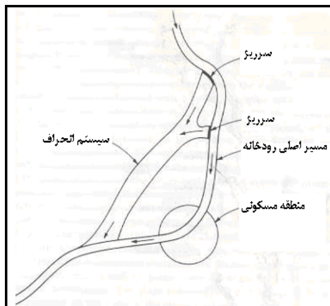
شکل ۸-۳- نمای ساده شده‌ای از یک سامانه انحراف سیلاب
