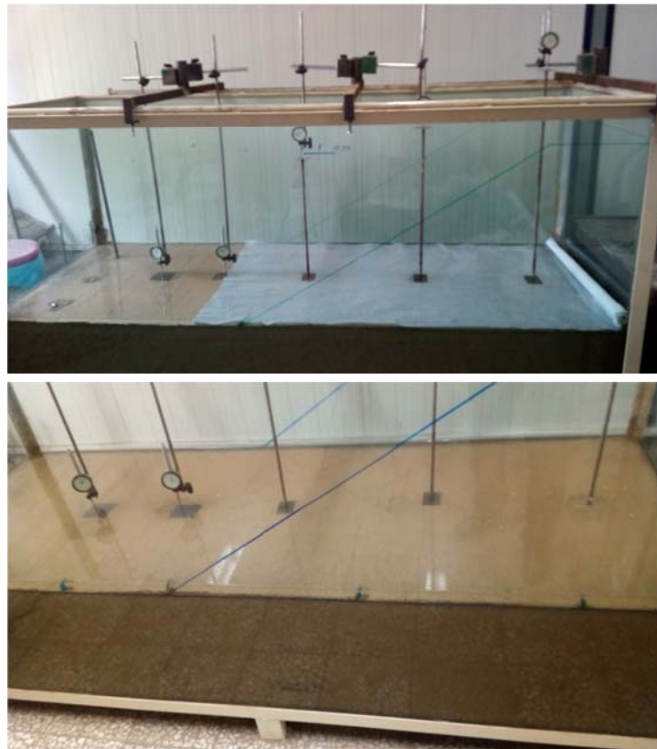
شکل (۴-۱۶) تصاویری از ابزارگذاری‌های انجام شده در جعبه مدل‌سازی فیزیکی ثقلی دانشگاه خوارزمی
