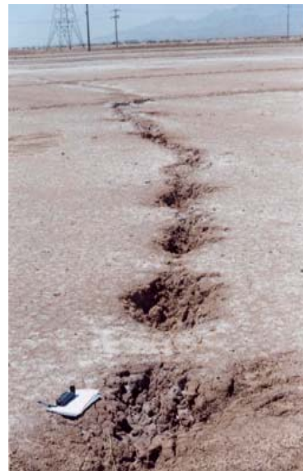
شکاف ایجاد شده ناشی از نشست زمین در منطقه کاظم‌آباد
