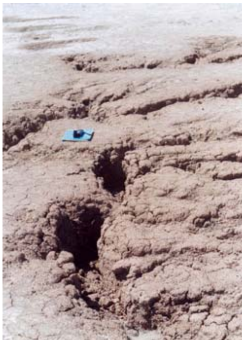
شکاف ایجاد شده ناشی از نشست زمین در منطقه کاظم‌آباد
