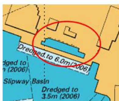
شکل ۳۹: یک ناحیه داک (Dock) با عمق نامشخص، ناحیه عمق در اینجا با DRVAL1=0 و DRVAL2=2 کدگذاری می شود.
