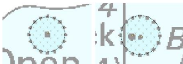
شکل ۵۸: نمونه‌ای از LNDARE نقطه‌ای داخل محدوده OBSTRN
