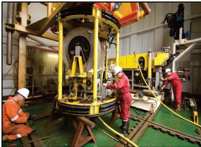
شکل ۴-۱۲- بررسی اتصالات و سامانه نگه‌دارنده TMS
