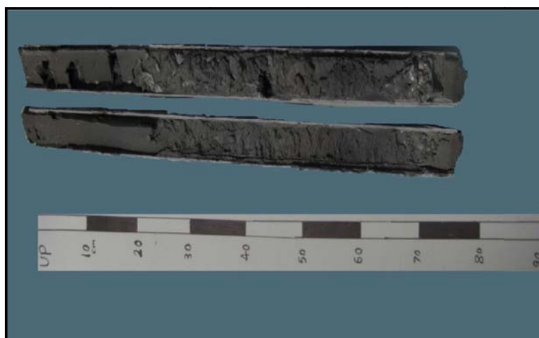
شکل ۳-۲۲- نمونه مغزه تقسیم شده به وسیله طبقه فولادی
