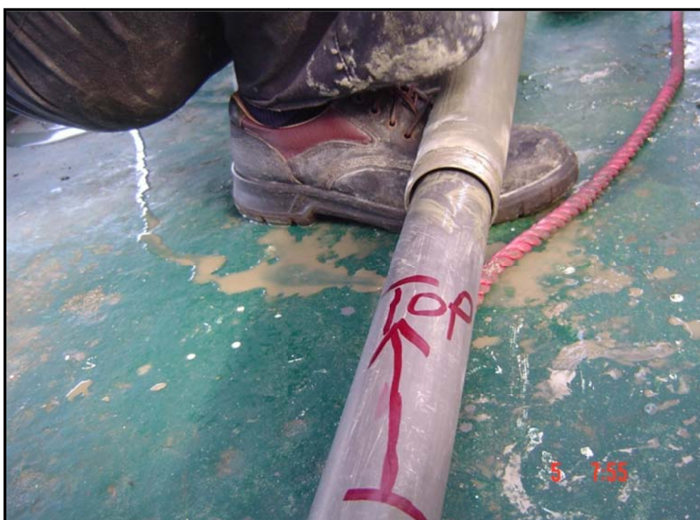
شکل ۲-۱۳- مشخص نمودن بخش بالایی و پایینی رسوب در لوله
