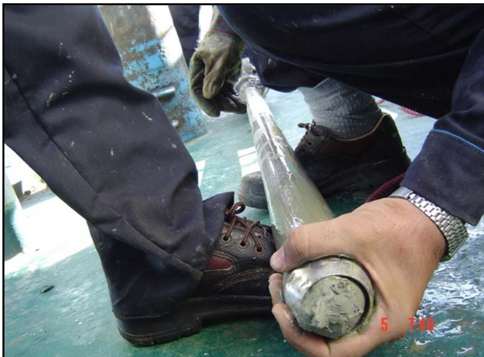
شکل ۲-۱۲- جدا نمودن نمونه از مغزه‌گیر
