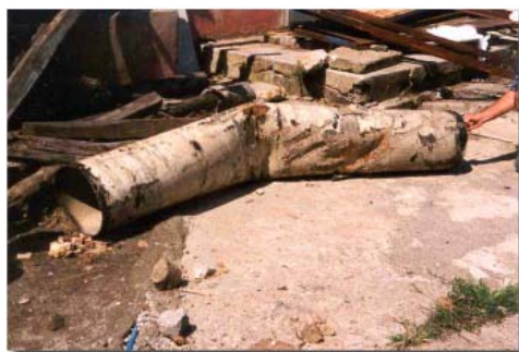
شکل ۲-۱۴ آسیب لوله در برخورد با گسیختگی‌ها
