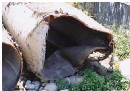
شکل ۲-۱۴ آسیب لوله در برخورد با گسیختگی‌ها
