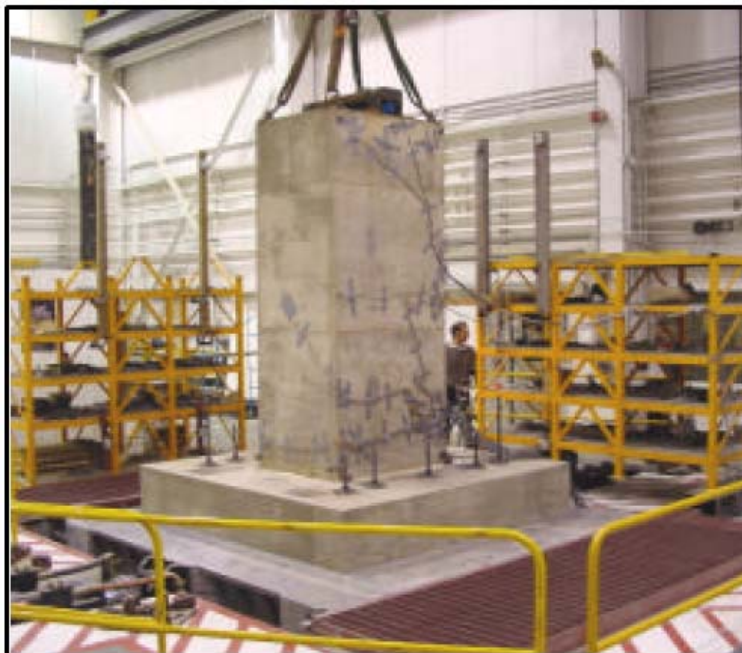
شکل ۲-۸ - آزمایش میز لرزان روی برج آبیگر سد
